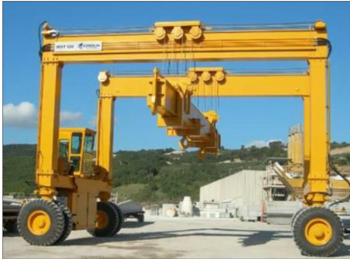
Abbildung 3: Portalhubwagen zum Handling der HGÜ-Kabeltrommeln (beispielhaft)
